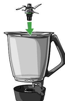
1. Zorg dat de dichtingsring van het mes correct is aangebracht op het draagvlak van het mes.
